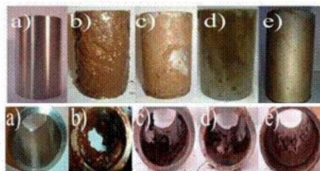
a)未污染模拟钻具 b)基浆 c)基浆+0.1%KSZJ d)基浆+0.2%KSZJ e)基浆+0.5%K=SZJ
