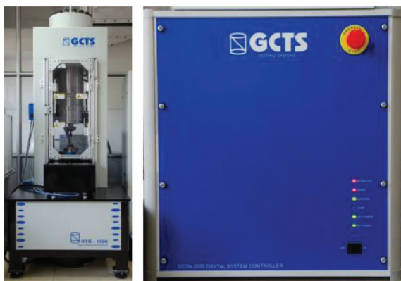
图1 RTR-1500测试系统及控制面板
