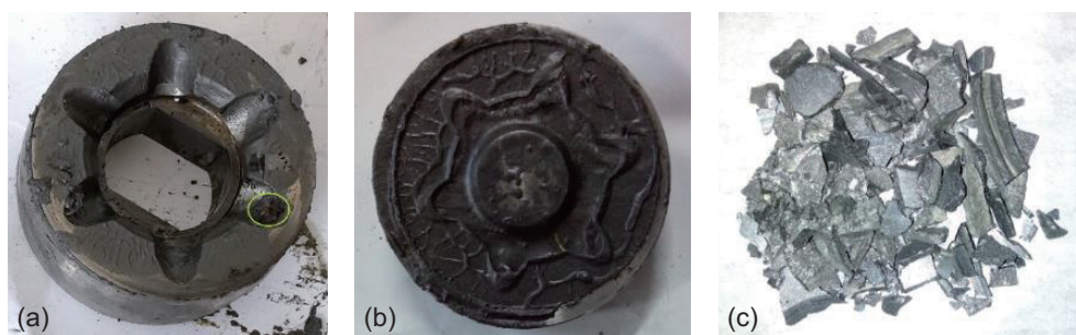
图 4 试验后的试样(上试样(a),下试样(b))及摩擦产物(c)
