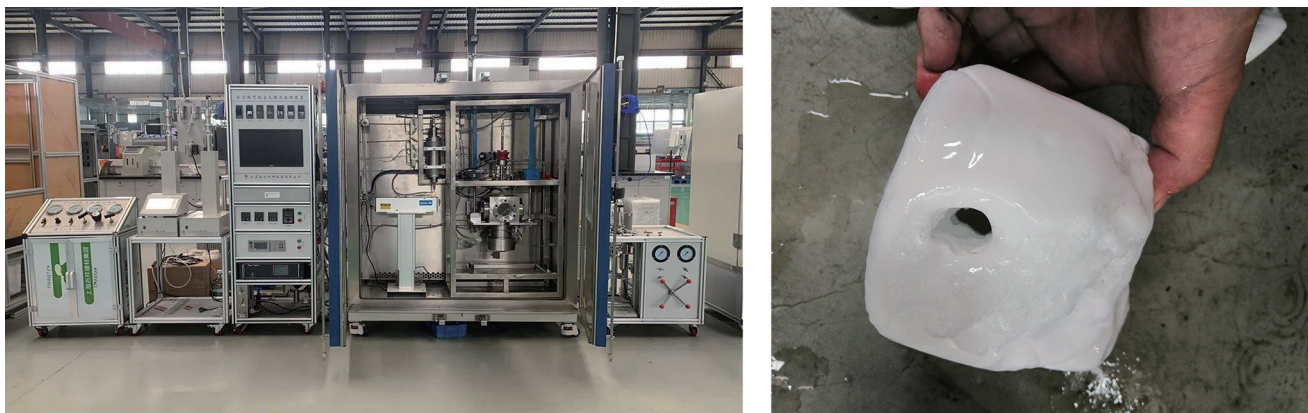
图 10 天然气水合物原位合成及射流冲蚀装置及纯水合物样品的冲蚀坑
