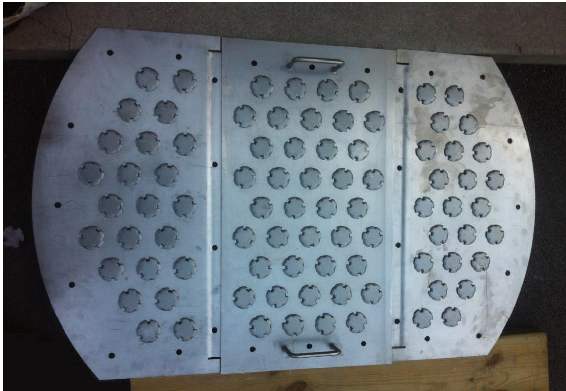
11、“工业规模蒸馏塔段模型平台”—塔板组装正面照（安装浮阀）
