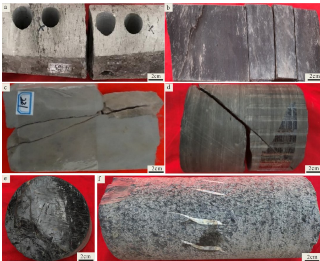
图3 鄂尔多斯盆地南部长7油层组不同岩性中的构造裂缝
