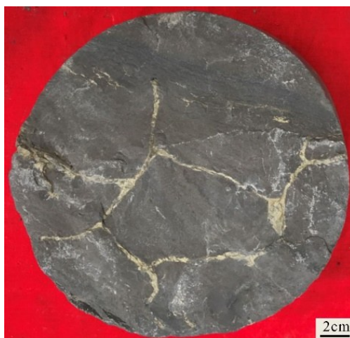
图8 鄂尔多斯盆地南部长7油层组收缩裂缝照片(L2井,939.81 m;井位如图1b所示)
