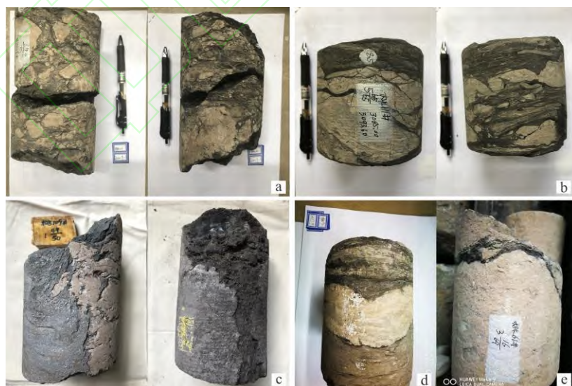
图 3 奥陶系马家沟组溶洞充填石炭系泥岩的岩心照片
