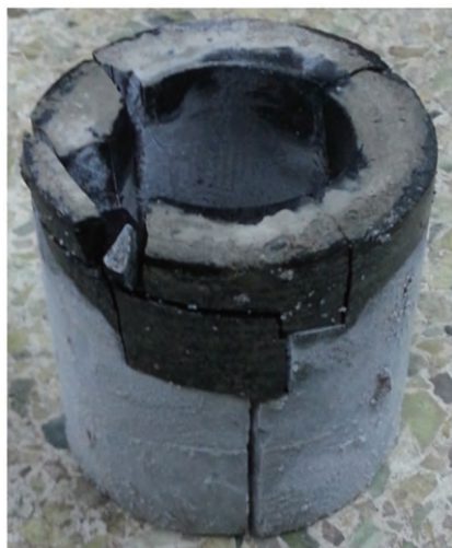
图 15 液氮汽化膨胀作用下的页岩 [27]
