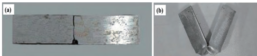
图3 液氮低温下(a)及回复室温后(b)的试件冲击破坏断口 [12]
