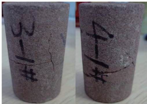
图 8 液氮冷却饱水砂岩 [21]
