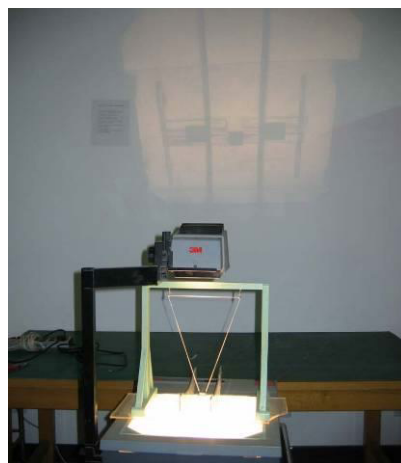
钕铁硼(Nd-Fe-B)制作的新型电磁阻尼演示仪
