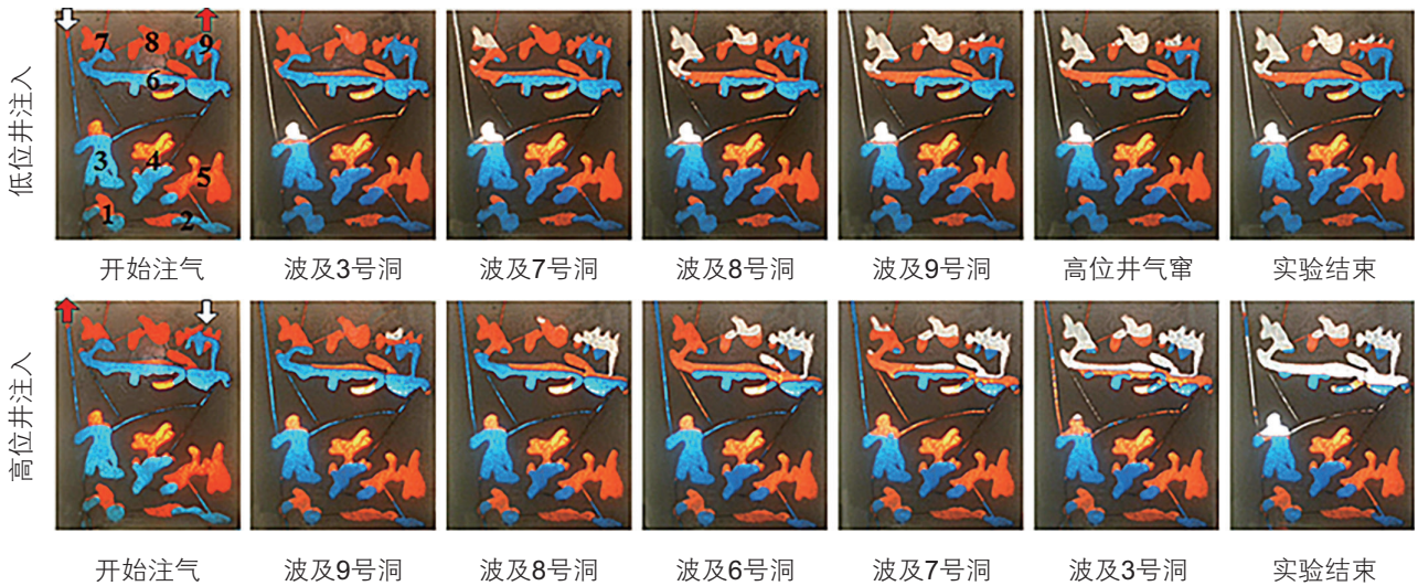
图9 氮气注入井别优化驱替过程
