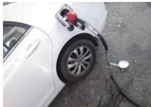
图3 加油站油品电荷密度现场测试图
