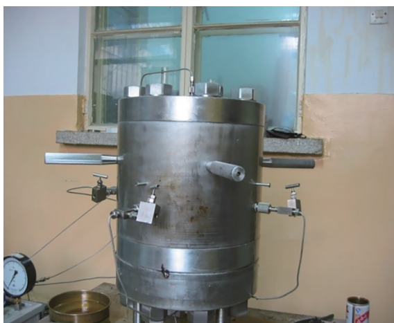
图5 真三轴模拟实验系统照片
