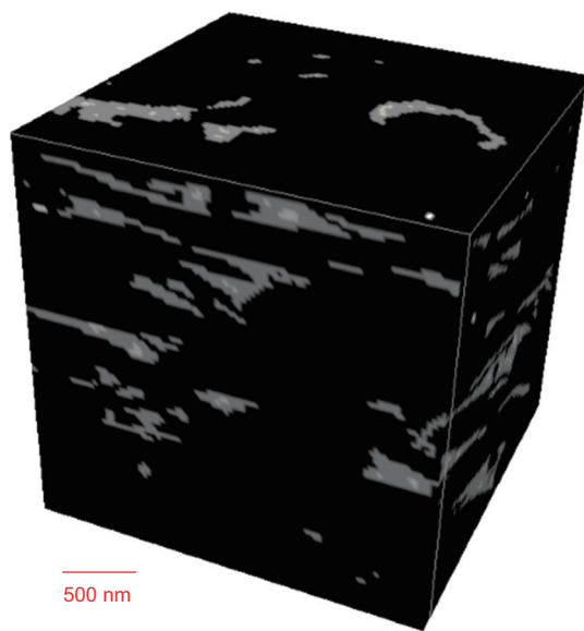
图8 重构页岩样品三维数字岩心,其中深灰色代表有机质,灰色代表有机质孔隙,白色代表基质孔隙,黑色代表基质
