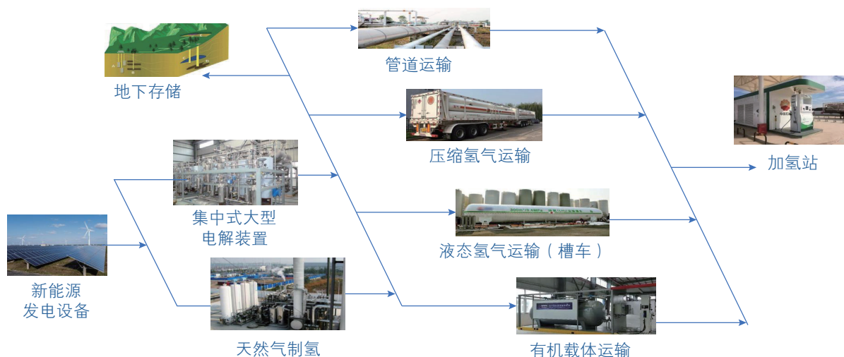
图1 氢能制—储—运关键基础设施
