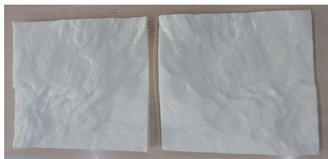
图2 3D打印粗糙裂缝模型
