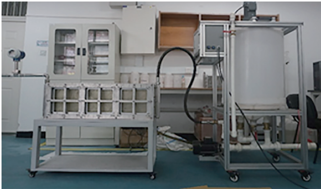
图3 支撑剂运移铺置可视化装置
