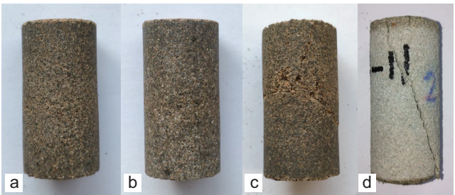
图 12 不同固化体系岩心单轴破坏形态(a. E44/650; b. E44/MHHPA; c. 2021P/MHHPA; d. 天然岩心)
