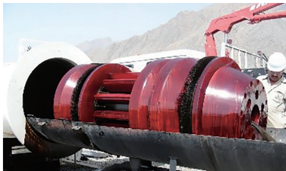
图 1 清洁与检测的清管机器人(清管器)
