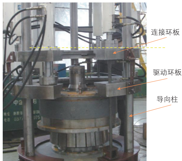
图 11 倾斜的环板导致干涉现象
