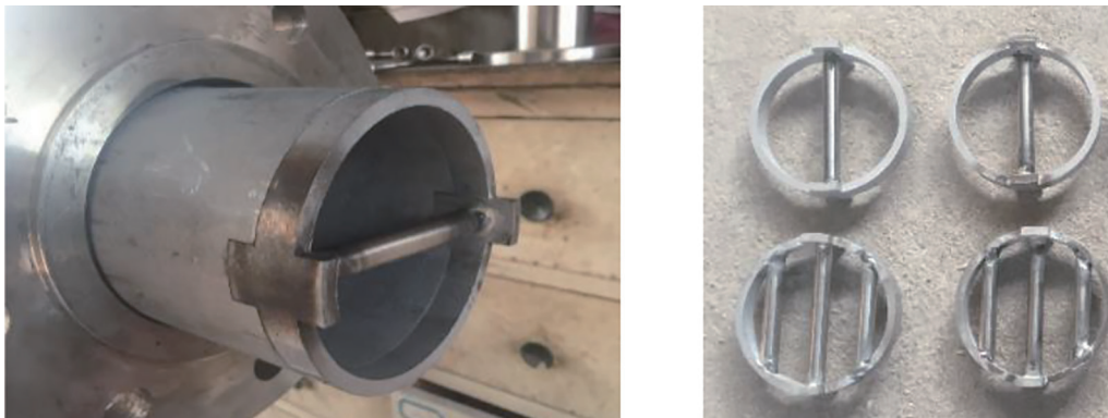
图 4 障碍物实物及卡槽结构示意图 Fig. 4 Obstacles and card slot structure diagram
