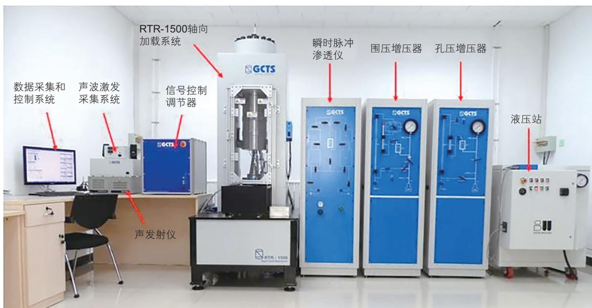
图 3 GCTS RTR-1500 高温高压岩石力学三轴仪
