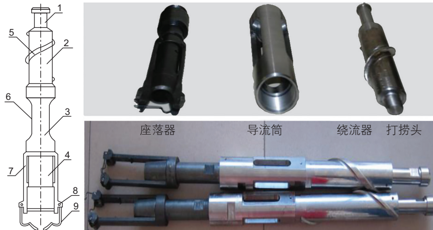
注: 1 打捞头, 2 绕流器, 3 导流桶, 4 座落器, 5 螺旋带, 6 出口口, 7 挡环, 8 卡簧轴销, 9 卡簧
