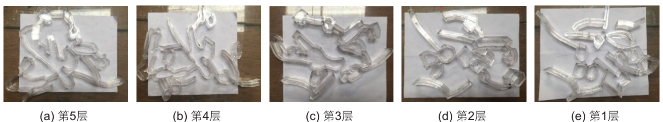
图2 激光刻蚀缝洞基本组合
