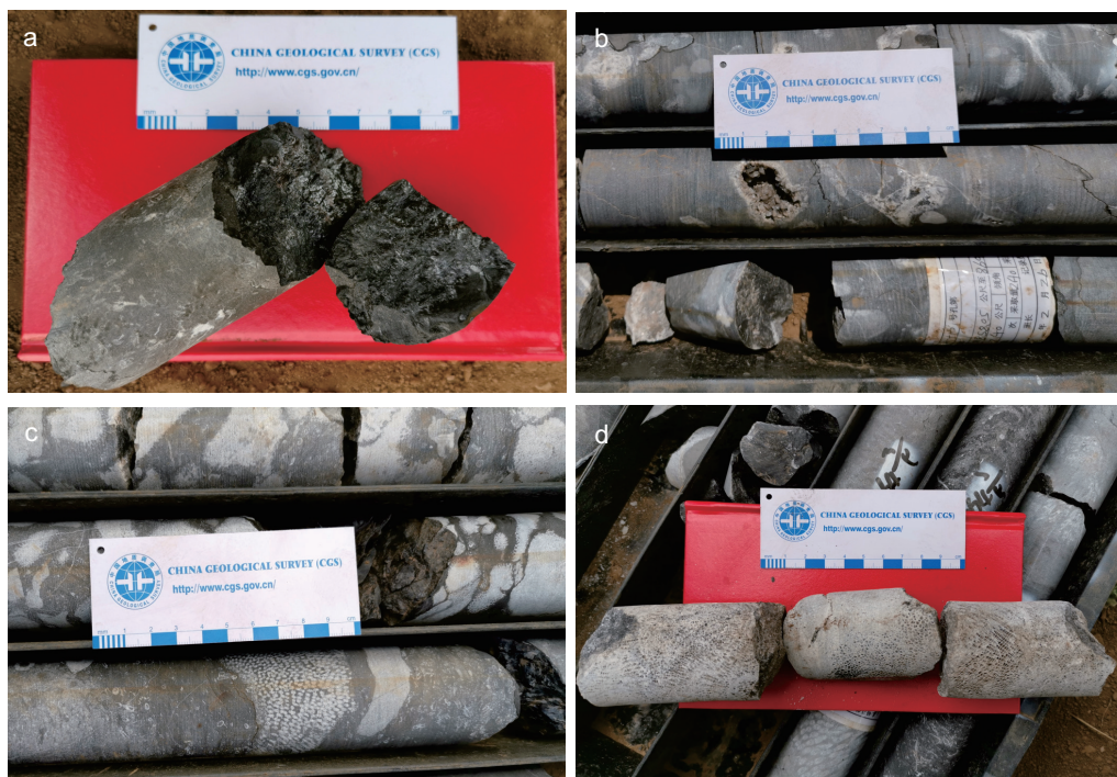
(a)沥青充填缝合线, 824 m; (b)溶蚀孔, 860 m; (c)层孔虫、珊瑚, 930 m; (d)珊瑚, 1063 m 图4 云宁地1井碳山坪组下段典型岩心特征
