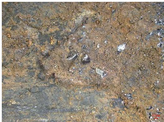
图34 L80 油管内壁腐蚀形貌体视照片 [86]
