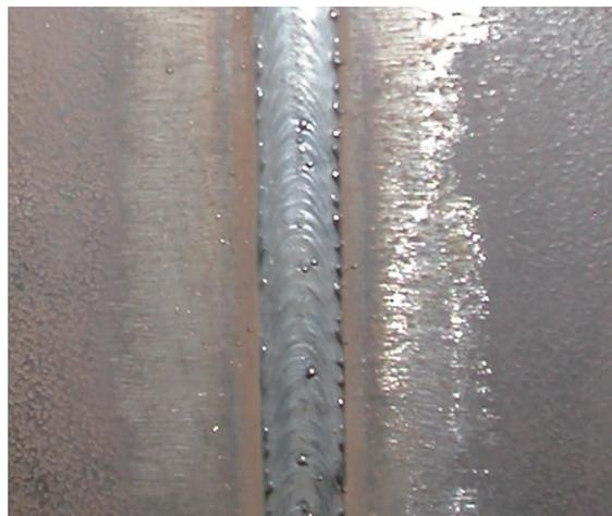
图 11 焊缝成形<sup>[40]</sup>
