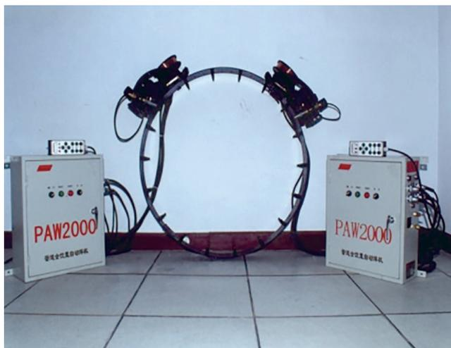
图 1 PAW2000 型管道焊接机器人
