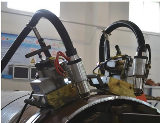
图 10 单焊炬双丝自动焊接机器人<sup>[40]</sup>
