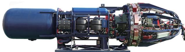
图4 管道内焊接机器人
