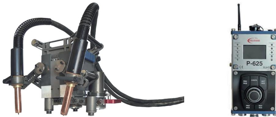
图 2 美国 CRC-EVANS 公司的 P625 型管道焊接机器人<sup>[7]</sup>
