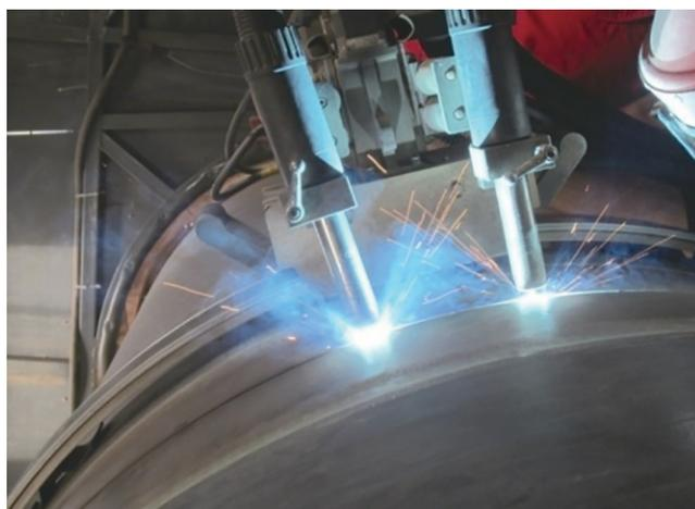
图6 机器人焊接过程
