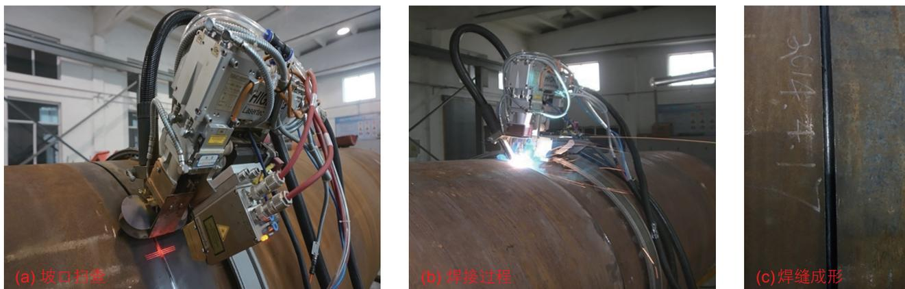
图 8 激光—电弧复合管道焊接机器人<sup>[28]</sup>Fig. 8 Laser-arc hybrid welding robot for pipeline<sup>[28]</sup>
