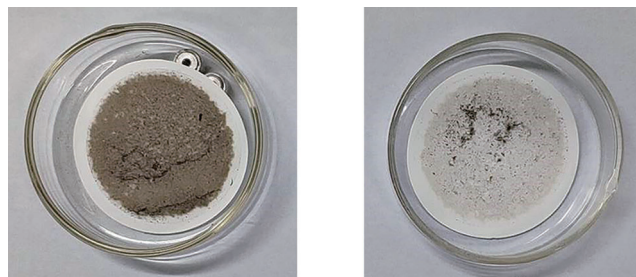
图8 实验e中泵站B油样固体杂质情况
