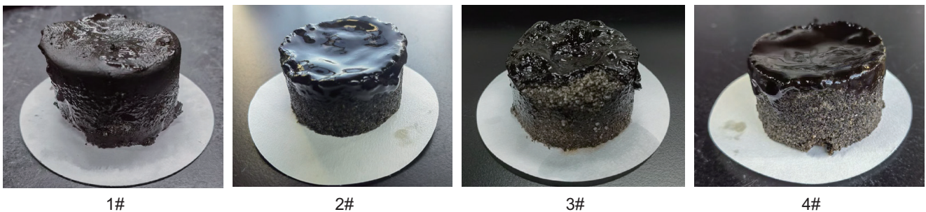
图 12 不同目数砂床堵漏实验后砂床状态
